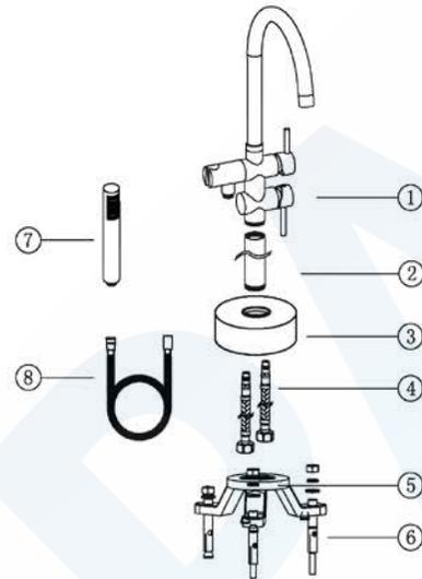
1. Verbinden Sie den Halter mit der Zierkappe und schrauben Sie ihn auf das gerade Rohr. Schieben Sie beide Schläuche durch das Rohr.
