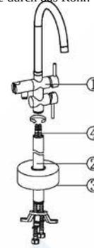
2. Schläuche an den Hauptkörper anschließen. Verschrauben Sie den Hauptkörper mit dem geraden Rohr.
