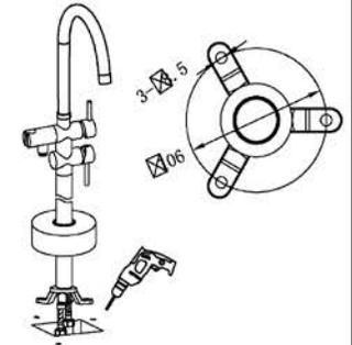
7. Ziehen Sie die Dehnschrauben an.
