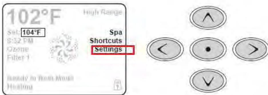
Selezionare “setting” all’interno del menù principale, confermare con il tasto “selezione/OK” , per accedere al sottomenù di settaggio dei parametri di funzionamento.
